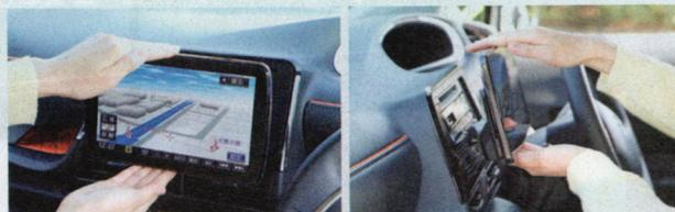
大画面で見やすいディスプレイが上下・左右の調整でベストポジションに! 前後の角度調整は約-20~60°と広範囲に可動できる。上下のスライドもできるので、見やすい高さに調節しよう。取り付け時に設定すれば、画面の奥行きも調整可能だ。
