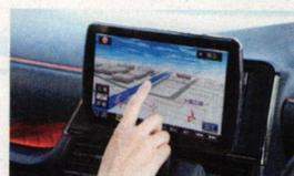
ドラッグした指の動きに即座に反応し、直感的な操作が可能。スライドした指の移動距離に応じた分だけマップが移動するなど、指と連動したためらかな操作感を実現している。
