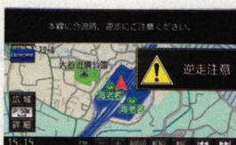
高速道路のSA・PAを出る時に起こりがちな逆走を事前に警告する機能。自車位置を自動測定してSA・PAにいたることを検知すると、エンジンの再スタート時に注意を促してくれる。
